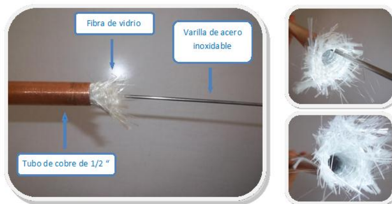
Figura 66: Introducción de la mecha o estructura capilar.
