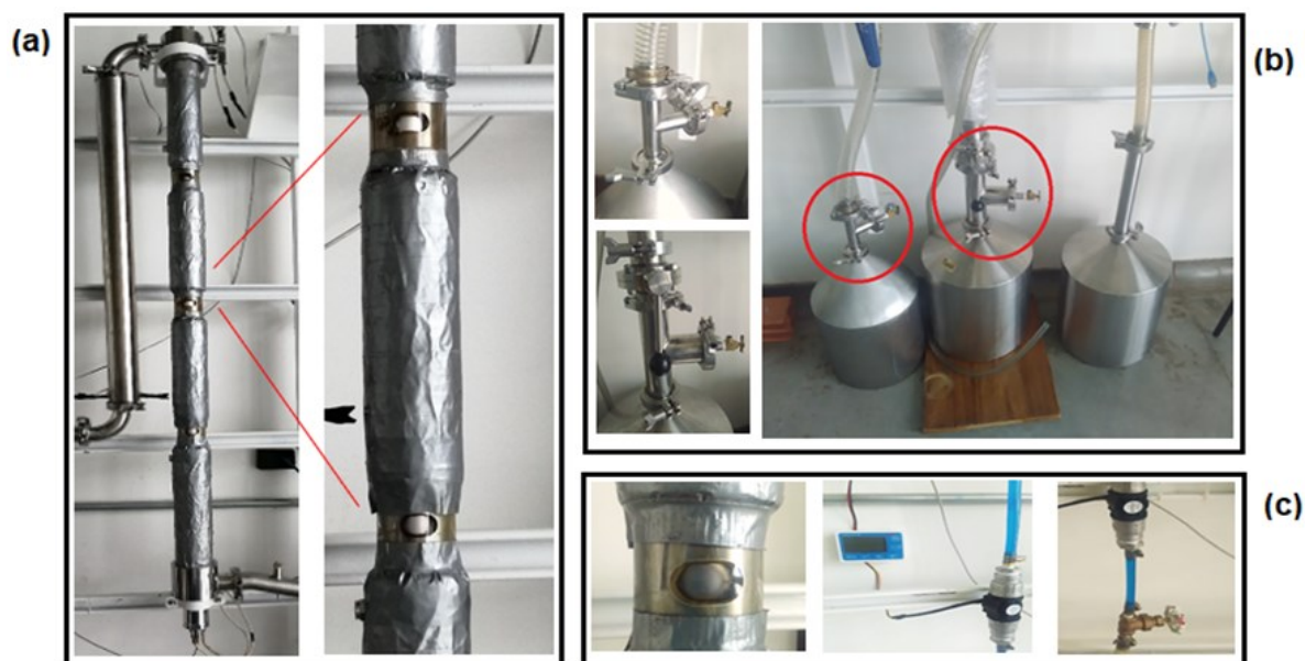
Figura 6. Principales cambios realizados al piloto de evaporación (carcasa, visores, uniones tipo T y flujómetro).
