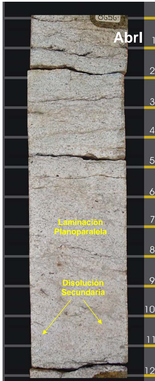
Foto 9. Facie Abri pozo Tibú 108K, se observa laminación paralela y disolución secundaria
