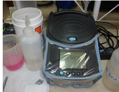
Figura 71. Medición de Cloro R.
