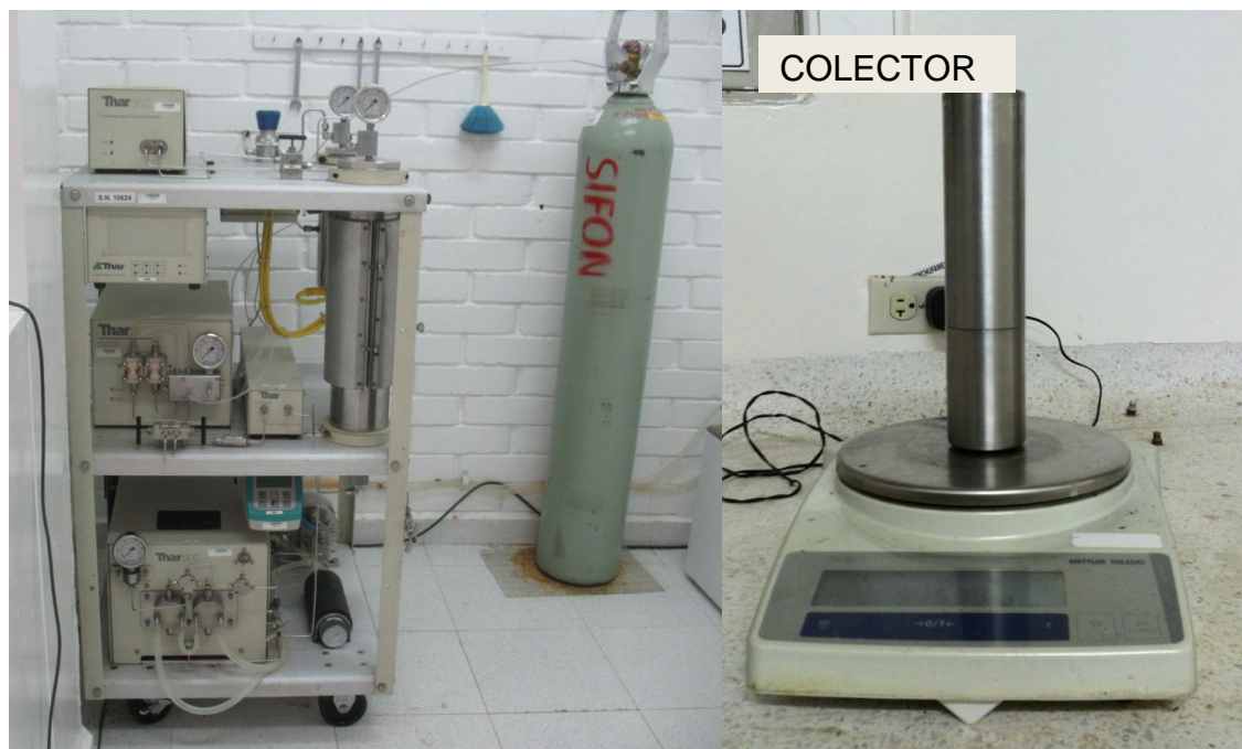
Figura 20. Equipo Thar SFE-2000-2-FMC50 empleado para obtener los extractos de las seis especies de Lippia spp. Fuente: Fotografía tomada por la autora. Lugar: Laboratorio Daniel Bernoulli, CENIVAM, UIS-Bucaramanga, el 27 de abril de 2013.
