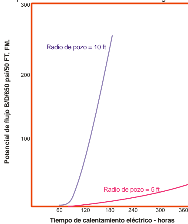
Figura 27. Potencial de flujo desarrollado utilizando electrodos alargados – modelo 3 – D.
