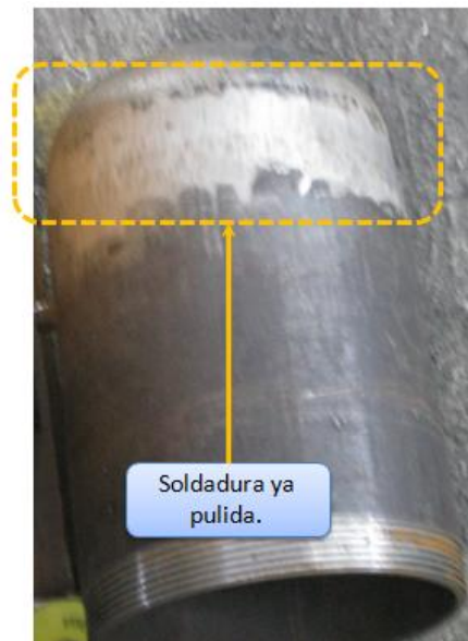
Figura 19. Tapa CAP y tanque soldados
