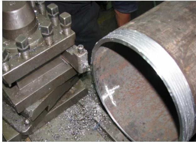
Figura 14. Proceso de torneado del tanque cilíndrico
