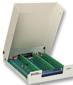
Figura 27. Tarjeta electrónica de distribución de puertos
