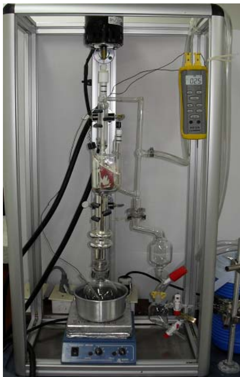
Figura 1. Equipo de destilación fraccionada B/R Instrument 800 - High Efficiency Micro Distillation
