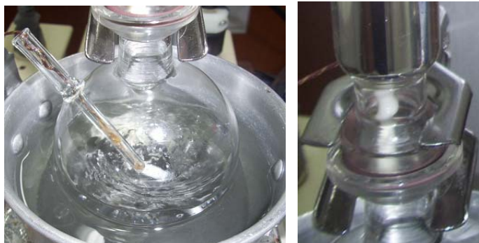
Figura 2. Balón de alimento y pinza para fijarlo a la columna
