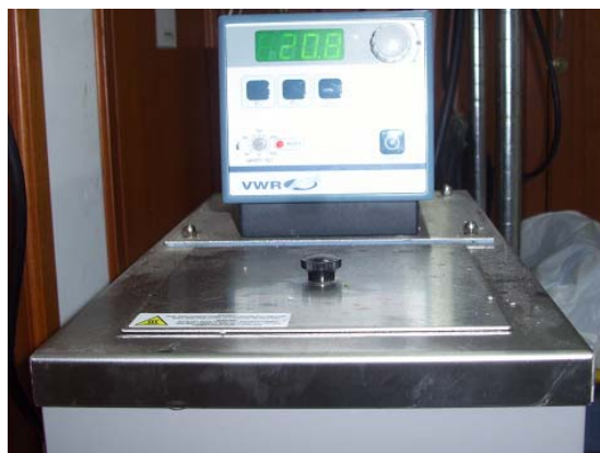
Figura 6. Baño de reciclo de agua
