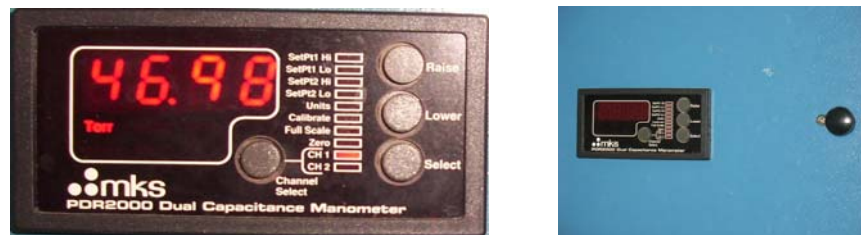
Figura 15. Manómetro dual capacitance manometer MKS PDR 2000
