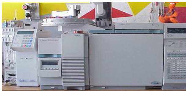
Figura 7. Cromatógrafo Agilent Technologies 6890 Plus Series GC System acoplado a un detector selectivo de masas Agilent Technologies MSD 5973 Network
