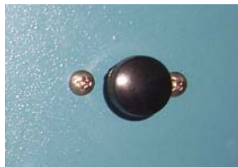
Figura 16. Válvula de despresurización
