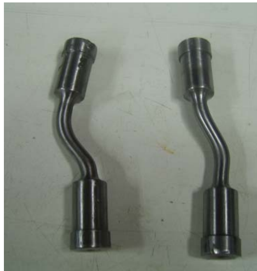
Figura 5. Probetas pandeadas durante los ensayos a compresión a causa del desalineamiento lateral de la máquina INSTRON.
