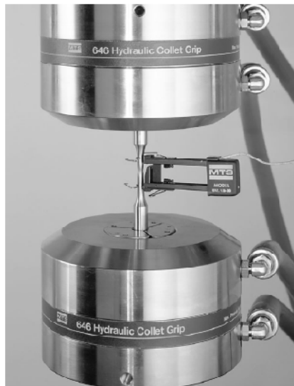
Figura 7. Mordazas MTS tipo 646 (Hydraulic Collet Grips). 4
