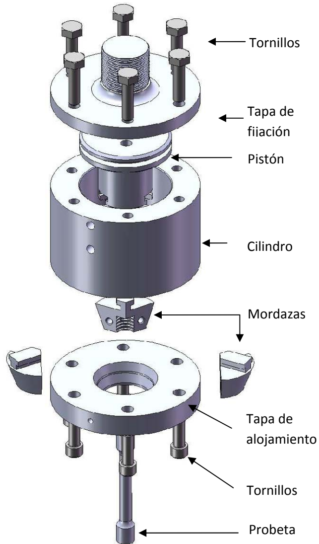
Figura 13. Sistema de mordazas hidráulicas (inferiores) de pistón hueco.
