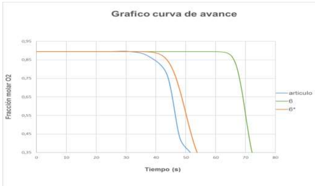
Figura 12. Fracción de oxígeno en la salida del lecho para las simulaciones 6 comparativo con el ajuste 6*, Beeyani et al 20 .
