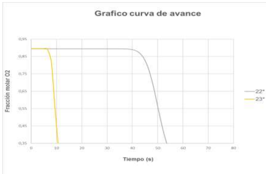
Figura 13. Fracción de oxígeno en la salida del lecho para las simulaciones 22* y 23* para los parámetros propuestos por Beeyani et al 20 . Donde 22* corresponde a las k_1 = 50000 \text{ S}^{-1} , k_2 = 50000 \text{ S}^{-1} y 23* k_1 = 5,0000e-10 \text{ S}^{-1} k_2 = 5,0000e-10 \text{ S}^{-1} .
