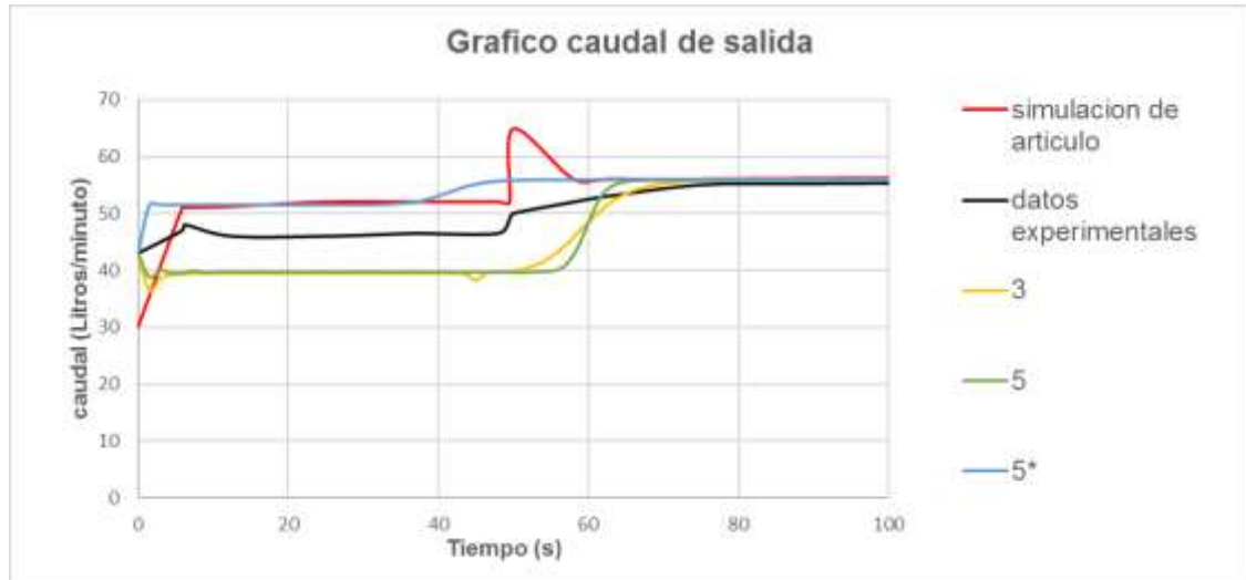
Figura 15. Comparación de los cambios realizados a la simulación propuesta como solución para la adsorción en el artículo Choung et al. 19 (Caudal de salida).
