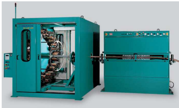
Figura 22. Máquina trenzadora disposición horizontal
