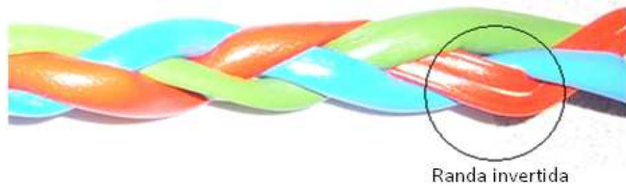
Figura 26. Fallas de sentido invertido
