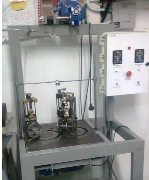
Figura 199. Trenzadora de randas terminada
