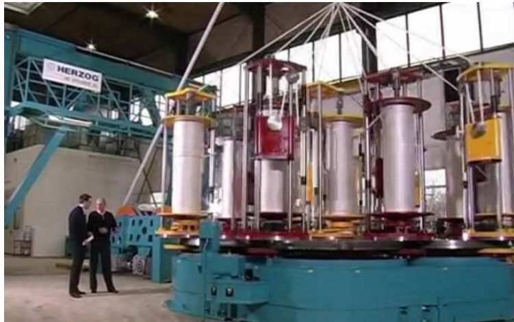
Figura 19. Maquina trenzadora de cuerdas de anclaje para barcos
