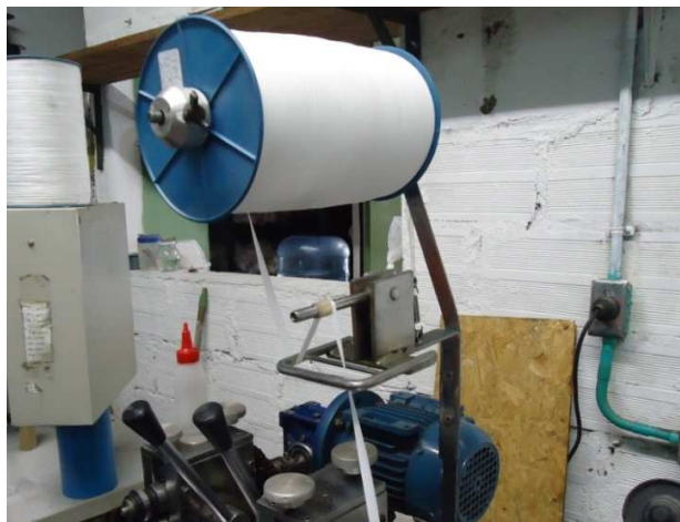
Figura 13. Bobina de hiladillo montado en la selladora de randas
