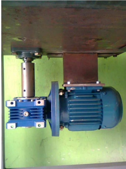
Figura 89. Montaje motor en el mecanismo trenzador
