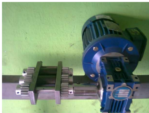
Figura 88. Montaje del motor con el mecanismo laminador.
