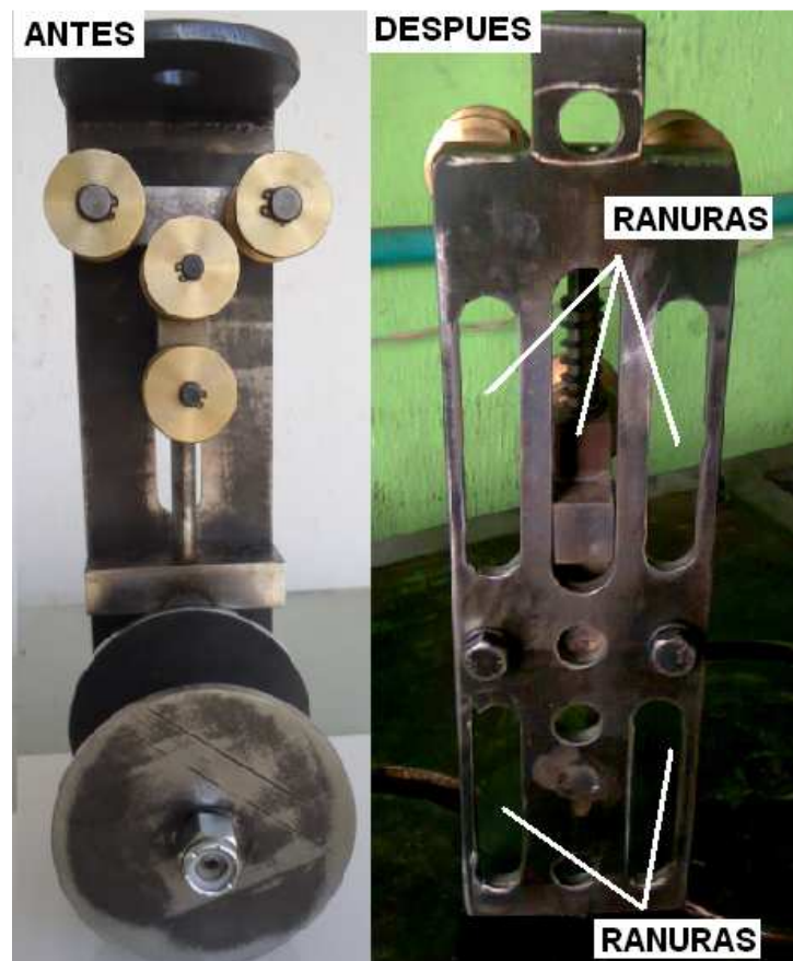
Figura 141. Antes y después de la estructura de la torreta
