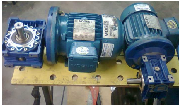
Figura 87. Motores VOGES de 1 hp y \frac{1}{2} HP unidos a los reductores de 1:10
