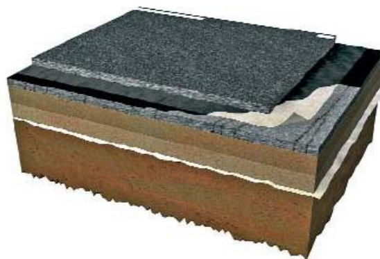
Figura 3.14. Sistema de interposición con geotextiles
