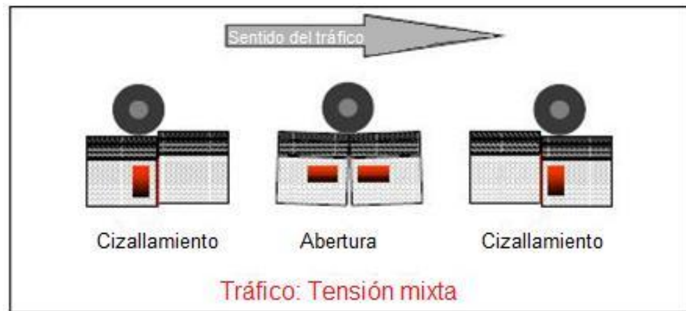
Figura 2.7. Solicitaciones experimentadas por la estructura del pavimento
