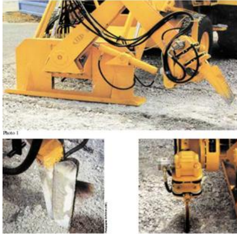
Figura 3.6. Equipo para prefisuración CRAFT
