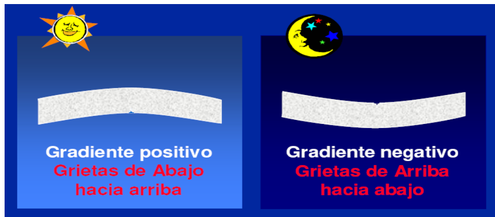
Figura 1.11. Alabeos por cambios estacionales de humedad
