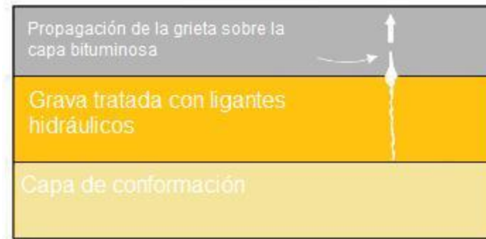
Figura 2.2. Reflexión de fisuras en calzadas semi-rígidas
