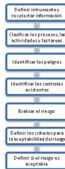
Figura 3.1: Actividades para identificar y valorar riesgos(GTC 45, 2010)
