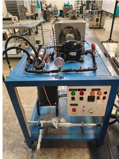
Figura 1: Banco de Pruebas de Intercambiadores de Calor Tubos Concéntricos
