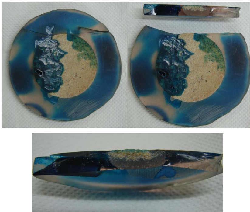
Figura 6-6. Adherencia de la resina coloreada con Rojo de Metilo a los granos de la muestra.
