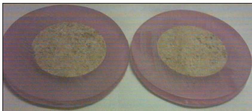
Figura 6-8. Recubrimiento del shale con la mezcla M1, relación 60:1.
