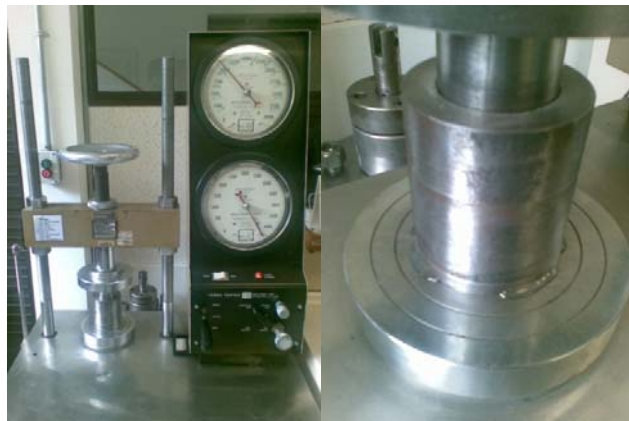
Figura 6-14. Compactación de los cortes en el equipo de compresión Soil Test.
