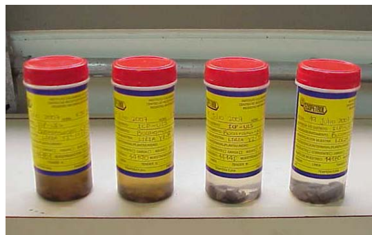
Figura 7-4. Muestras preservadas en aceite mineral obtenidas del pozo UIS-11 a profundidades de 14145 ft, 14180 ft, 14181 ft y 14190 ft.
