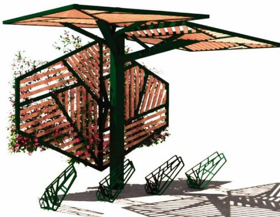
Sobre el modulo superior se cubrirá con policarbonato traslucido para que el solo no golpee directamente las bicicletas y las proteja de la lluvia.
