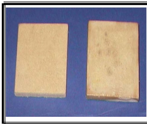
Fotografía 5.4 Piezas de MDF recubierta y sin recubrir después de ser sumergidas en agua
