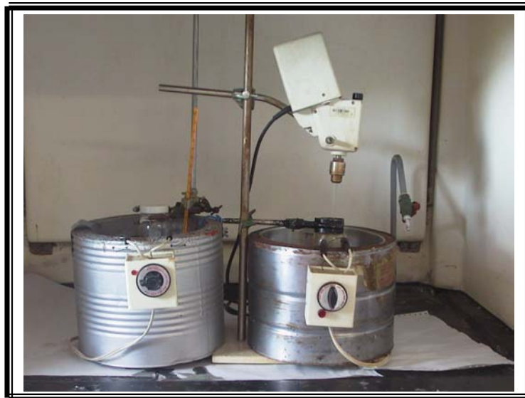
Fotografía 5.1 Montaje para la síntesis del recubrimiento
