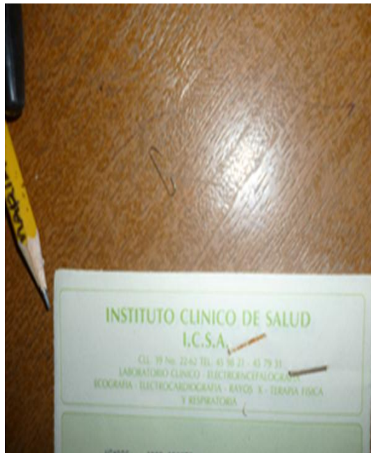
Imagen 20. Manchas de óxido transferidas por la indebida utilización de grapas metálicas y cintas autoadhesivas. 15 Enero 2014.
