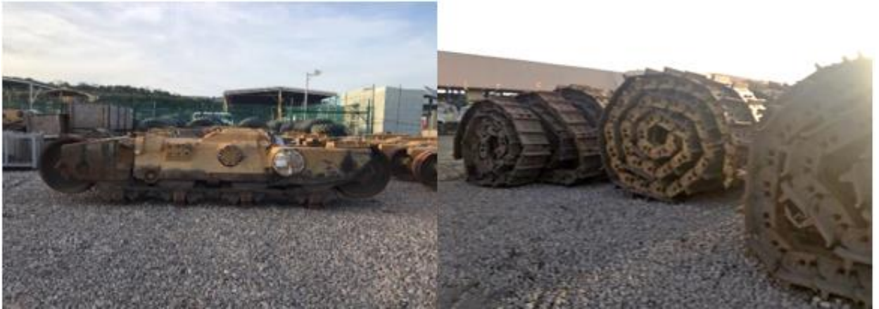
Figura 2. Bastidor y orugas del tractor
