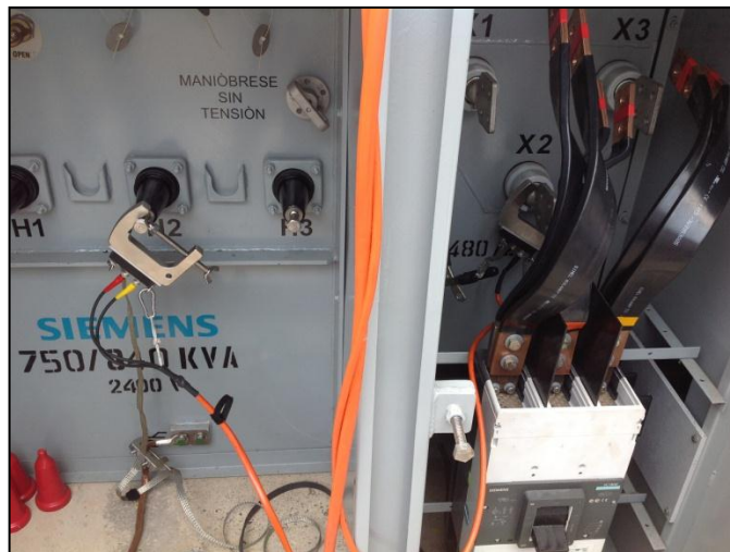
Figura 27. Conexión H2-X2 prueba de capacitancia entre bobinados
