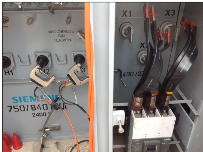
Figura 23. Conexión H3-H2 prueba de circuito abierto
