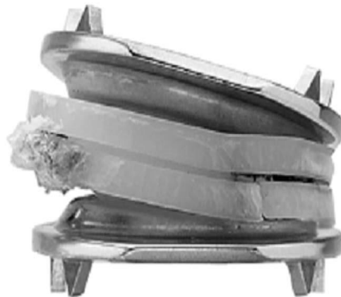
Figura 4. Componente de polietileno Fractura de una prótesis de disco lumbar
