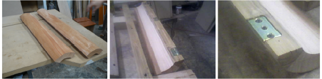
Imagen 46. Arriba grupo imágenes. Izq. curva a 90 en cedro macizo, maquinada en el trompo. Centro y derecha: se insertan 6 platinas con rosca para poder acoplar el bastidor y la plantilla de trabajo.
