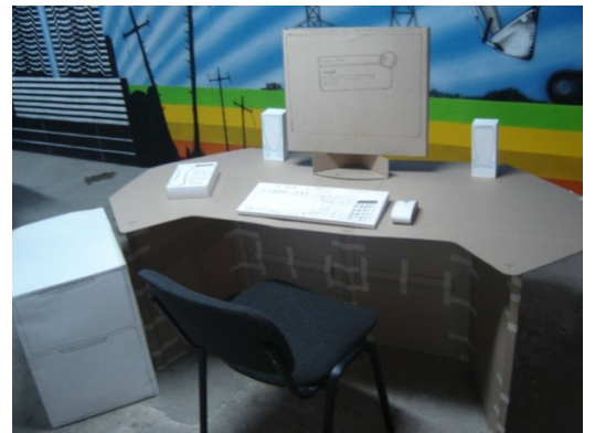
Imagen 19. Grupo de imágenes: Prueba ergonómica 1. Modelos de cartón del módulo 4exp, para un acercamiento dimensional más real.
