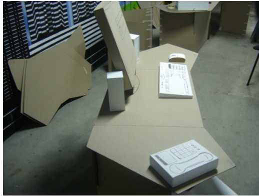
Imagen 18. Grupo de imágenes: Prueba ergonómica 1. Modelos de cartón del módulo 3exp, para un acercamiento dimensional más real.
