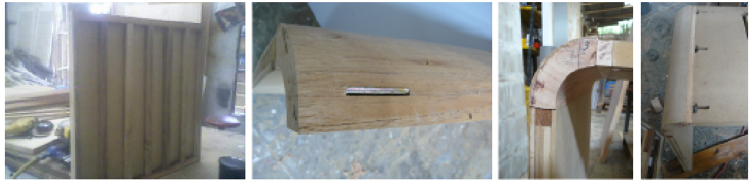
Imagen 47. Arriba grupo de imágenes de izq. a dcha. Primera imagen. Bastidor de la curva estructural. Segunda imagen: se ha ensamblado la curva maciza al bastidor. Tercera imagen: Curva estructural. Cuarta imagen: ensamble de la curva estructural a la plantilla mediante el roscado de 3 pernos con las platinas insertadas en la curva maciza.
