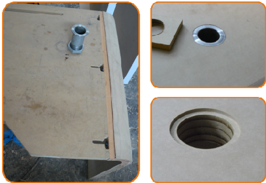
Imagen 50. Grupo de imágenes arriba. Buje soporte de la caja o estructura para la CPU, primer acercamiento para evaluación en la validación ergonómica.
