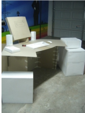
Imagen 17. Grupo de imágenes: Prueba ergonómica 1. Modelos de cartón del módulo 2exp, para un acercamiento dimensional más real
