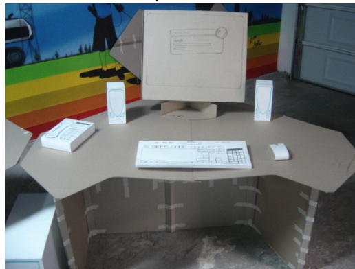
Imagen 19. Grupo de imágenes: Prueba ergonómica 1. Modelos de cartón del módulo 4exp, para un acercamiento dimensional más real.
