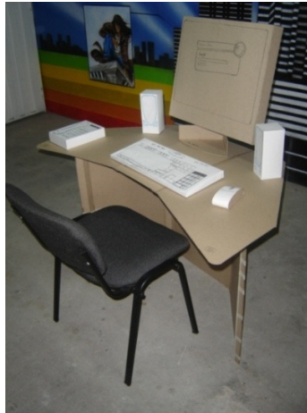
Imagen 20. Imagen Izquierda: Prueba ergonómica 1. Modelos de cartón del módulo 5, para un acercamiento dimensional más real.
