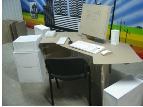
Imagen 17. Grupo de imágenes: Prueba ergonómica 1. Modelos de cartón del módulo 2exp, para un acercamiento dimensional más real
