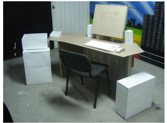
Imagen 18. Grupo de imágenes: Prueba ergonómica 1. Modelos de cartón del módulo 3exp, para un acercamiento dimensional más real.
