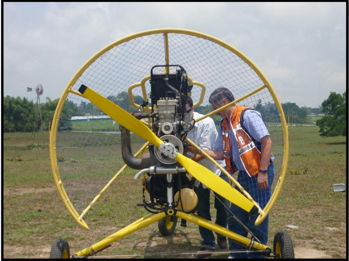
Figura 30. Canastilla construida e instalada.
