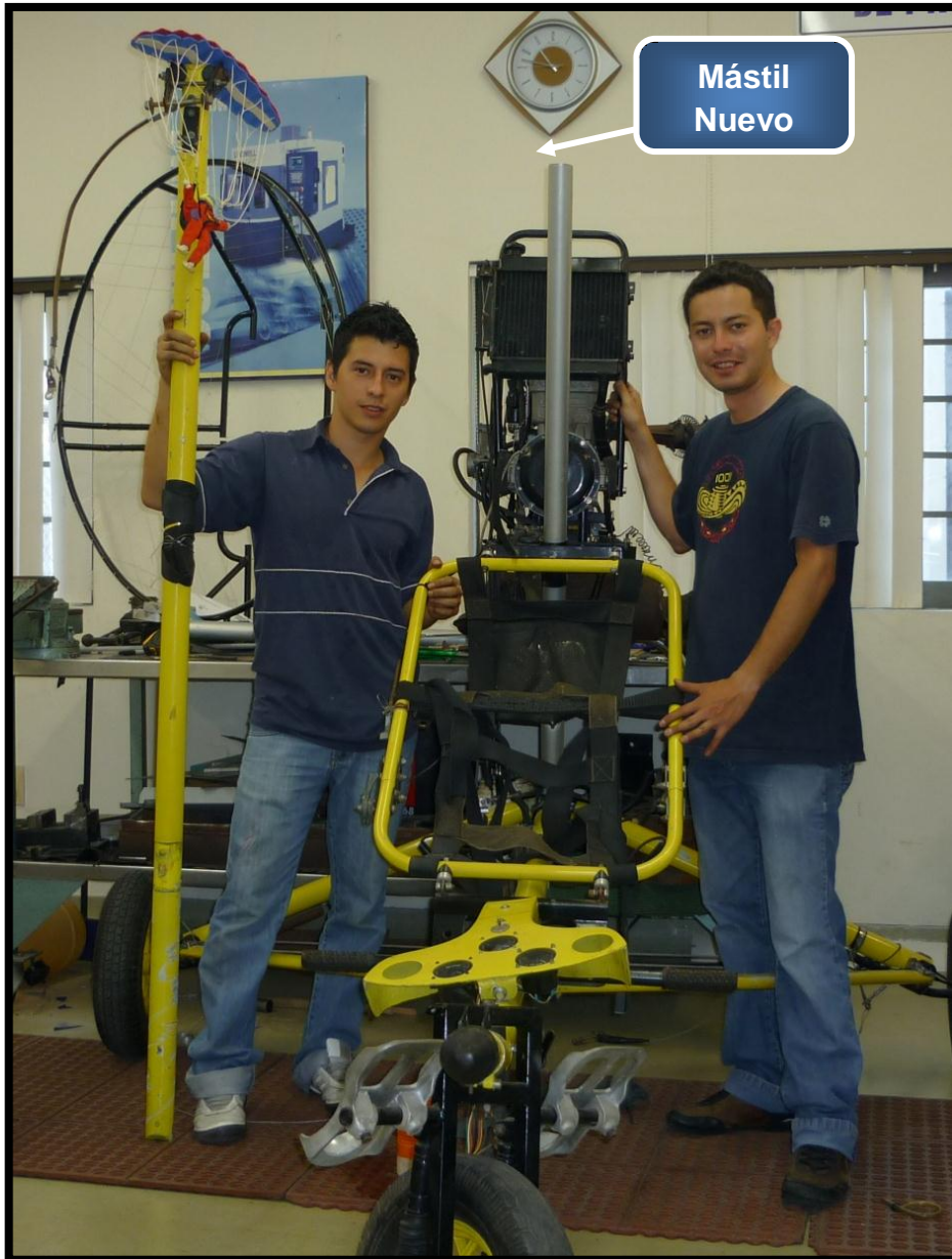
Figura 51. Reemplazo del Mástil.
