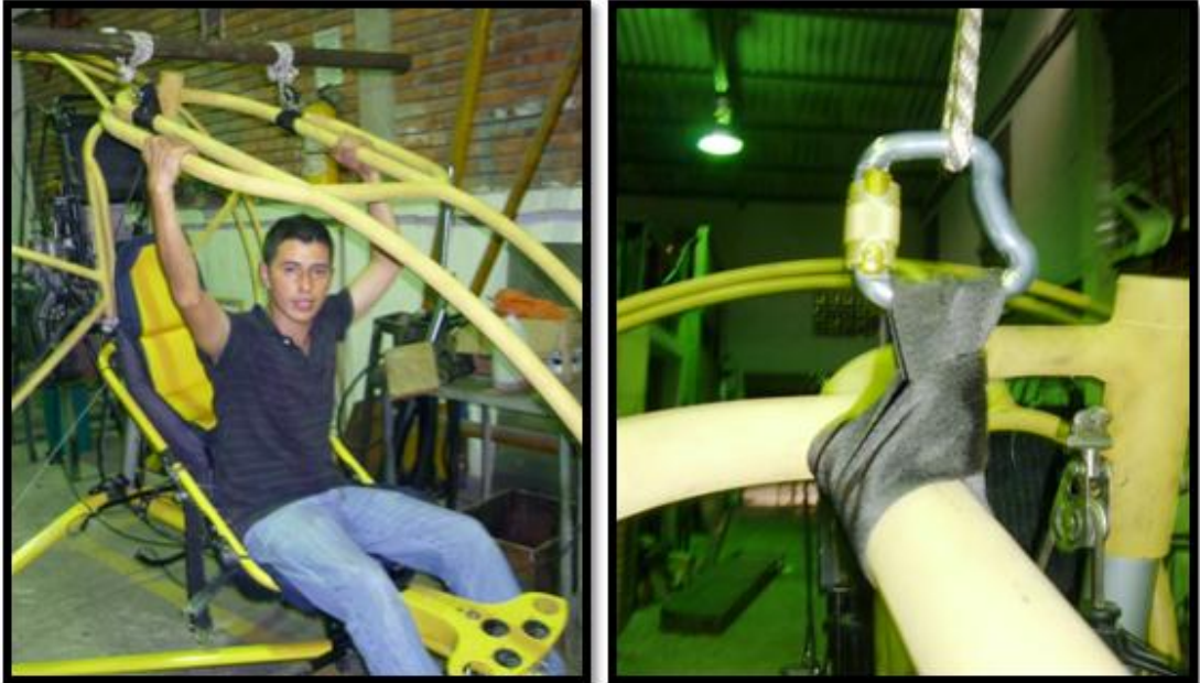
Figura 18. Detalle de los anclajes del parapente.
