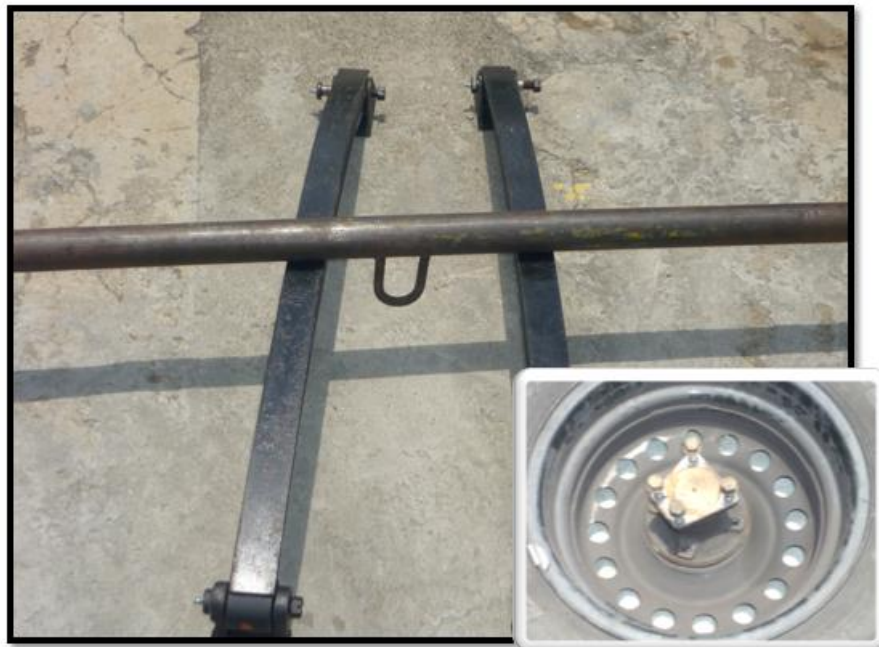
Figura 66. Muelles, eje, bocines y llanta del remolque.
