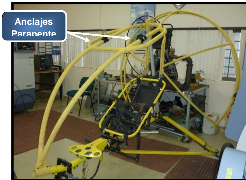
Figura 55. Bastidor Construido e instalado.
