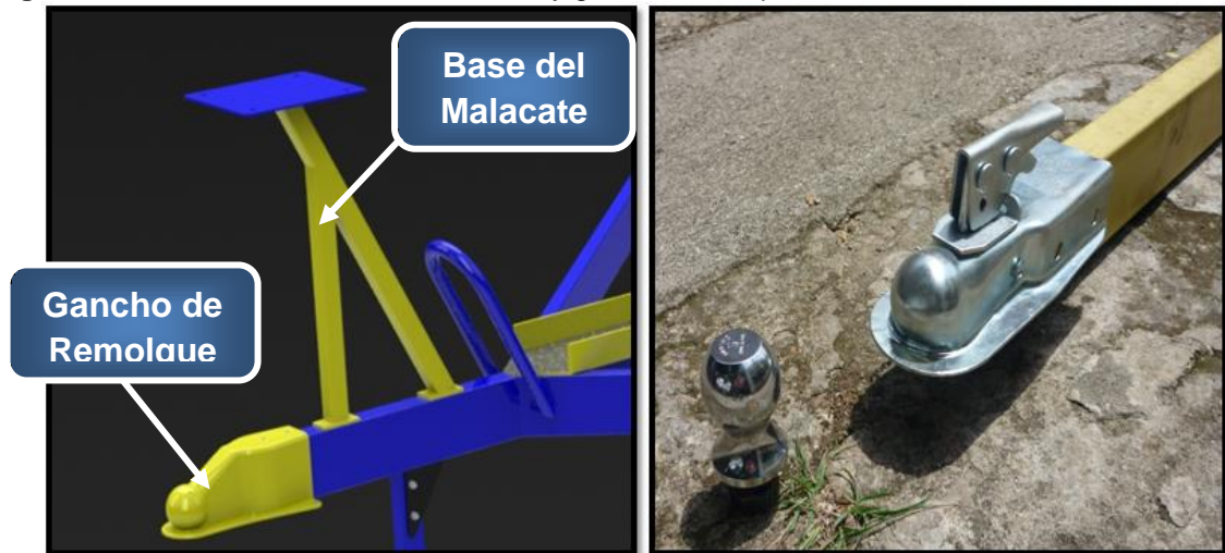
Figura 67. Detalle de la base del malacate y gancho remolque.
