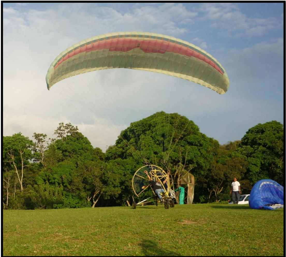
Figura 77. Prueba de Carreteo con Parapente.
