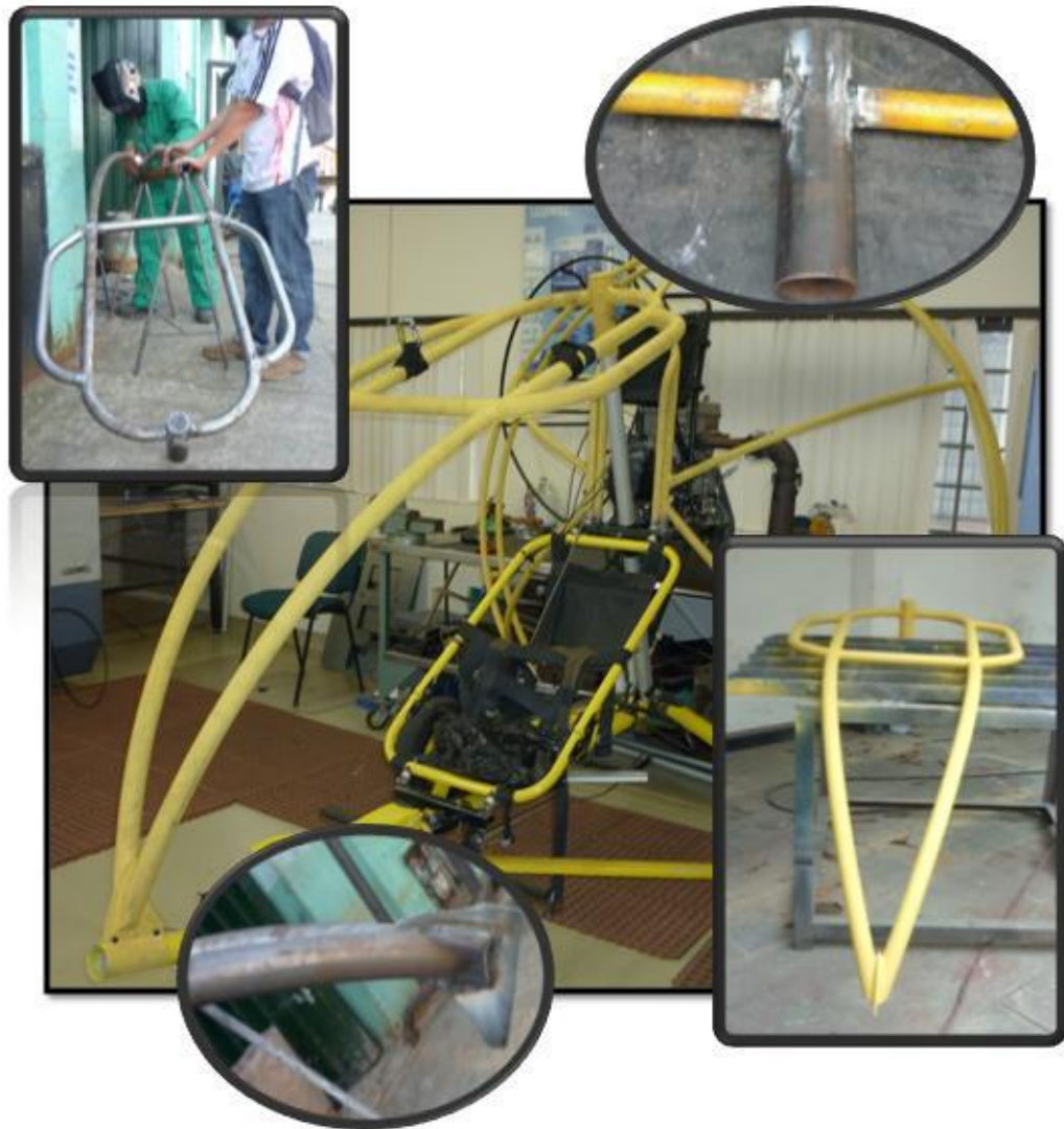
Figura 52. Procedimiento de Construcción Bastidor
