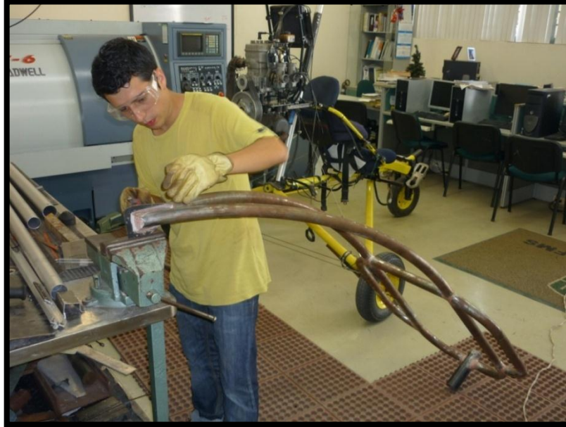
Figura 54. Inspección y acabado del Bastidor.
