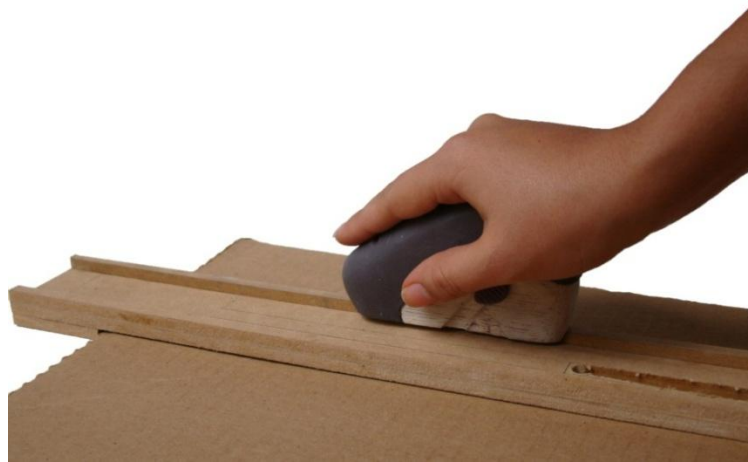
Figura 49. Prueba de riel deslizante del modelo N°1
