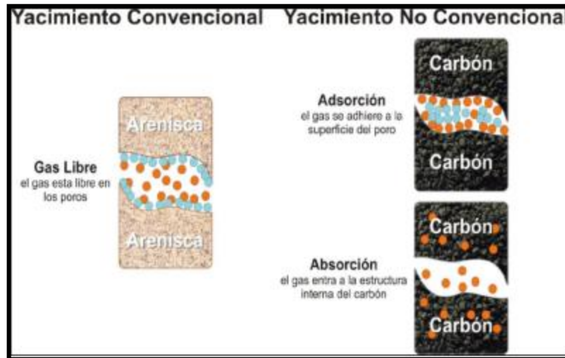
Figura 7. Mecanismo de almacenamiento de gas en mantos de carbón
