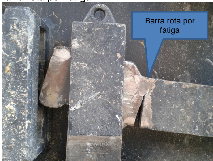
Ilustración 47. Barra rota por fatiga
