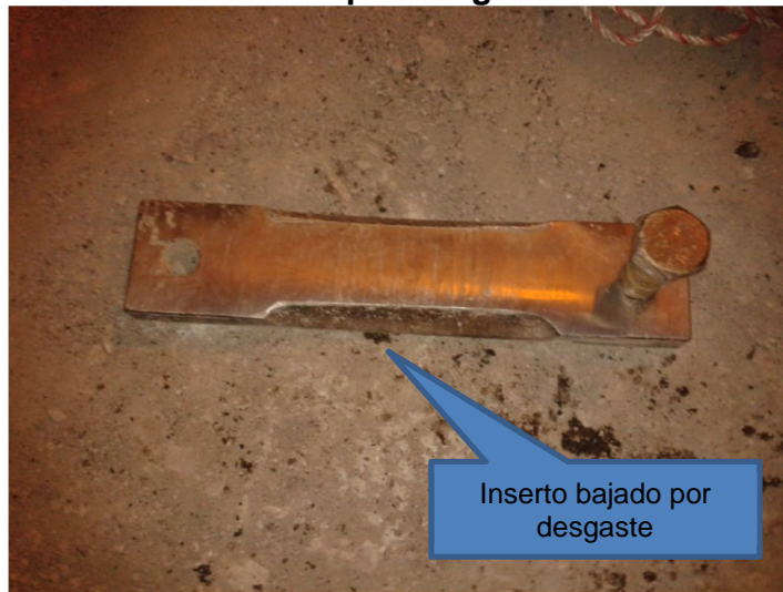
Ilustración 48. Inserto desmontado por desgaste
