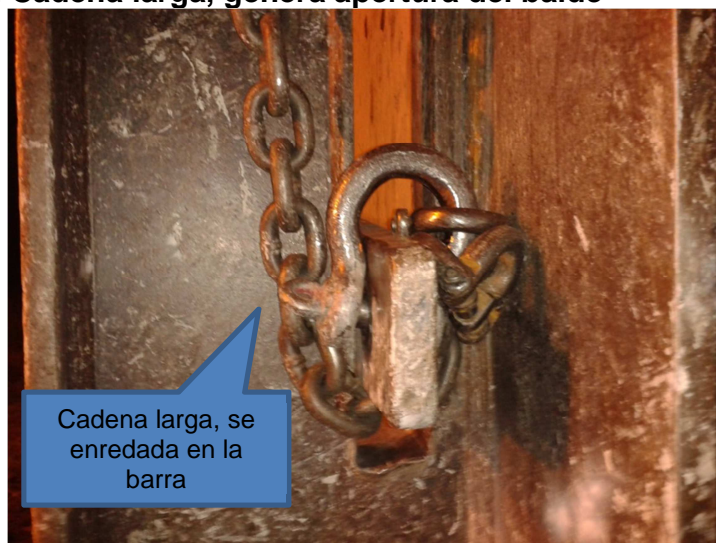
Ilustración 49. Cadena larga, genera apertura del balde
