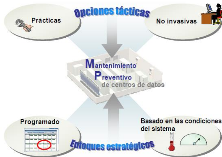
Figura 11. Panorama actual de mantenimiento preventivo en centros de datos
