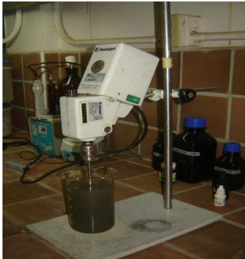
Figura 7: Lavado de las arenas con agitación a escala de laboratorio.
