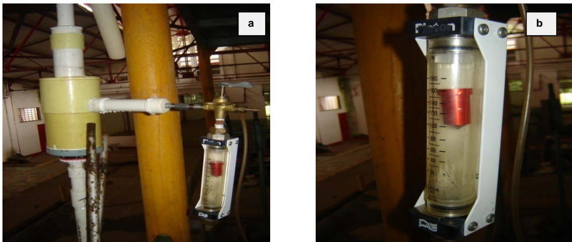
Figura 40: Instalación del prototipo de trompa de vacío y medición de flujo de aire y presión vacío.
