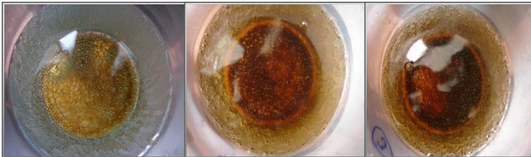
Figura 23: Secuencia de liberación de oxígeno y formación de óxido cúprico durante la neutralización catalizada con \text{Cu}^{+2} de una solución sintética de cianuro a 10^{\circ}\text{C} .
