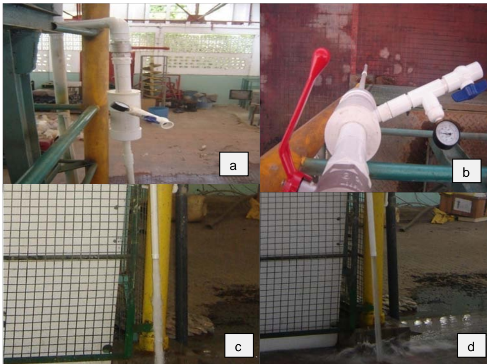
Figura 41: Ensayo del prototipo final de la trompa de vacío para uso industrial.
