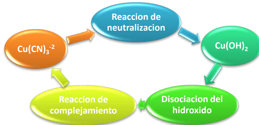
Figura 28: ciclo de la reacción catalítica del cobre en el proceso de neutralización de cianuro con peróxido de hidrógeno
