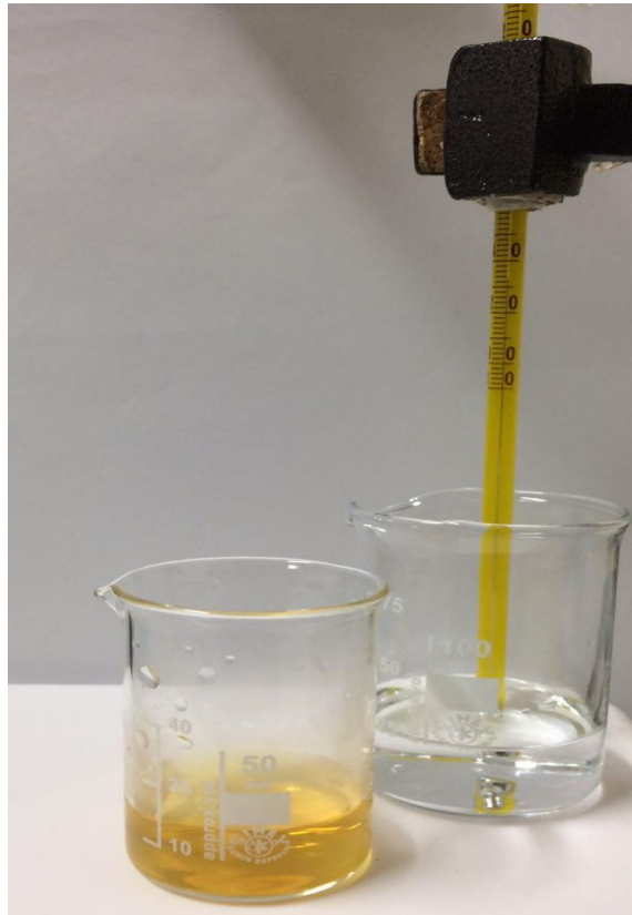
Figura 6. Montaje y coloración de la solución preparada con citrato de sodio, ácido ascórbico, y nitrato de plata, para la reducción de las nanoparticulas de Ag.
