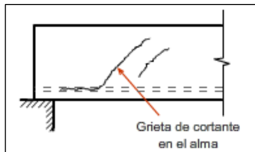
Figura 26. Agrietamiento por cortante.
