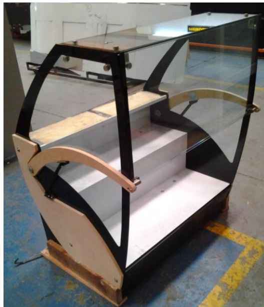
Fig. 162 Ensamble de vidrios y accesorios
