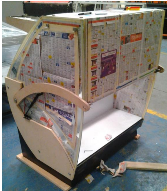
Fig. 160 Ensamble de vidrios y accesorios
