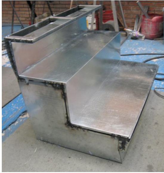
Fig. 157 Ensamble tanque exterior e interior
