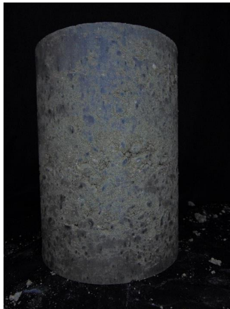
Figura 2. Probeta con humedad de 9.29% – Toma cara lateral
