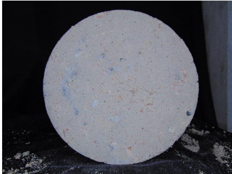
Figura 21. Probeta con humedad de 11.98% – Toma superior
