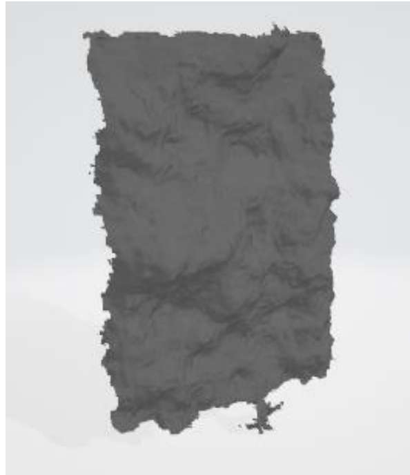
Figura 35. Probeta con humedad de 11.36% – Toma falla 1
