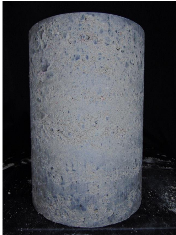
Figura 14. Probeta con humedad de 10.31% – Toma cara lateral
