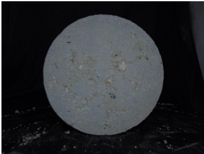
Figura 10. Probeta con humedad de 13.64% – Toma cara superior
