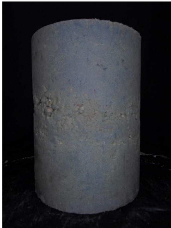
Figura 8. Probeta con humedad de 12.36% – Toma cara lateral
