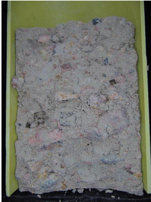
Figura 23. Probeta con humedad de 11.98% – Toma falla 1
