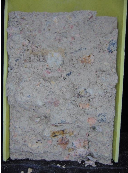
Figura 19. Probeta con humedad de 11.36% – Toma falla 1
