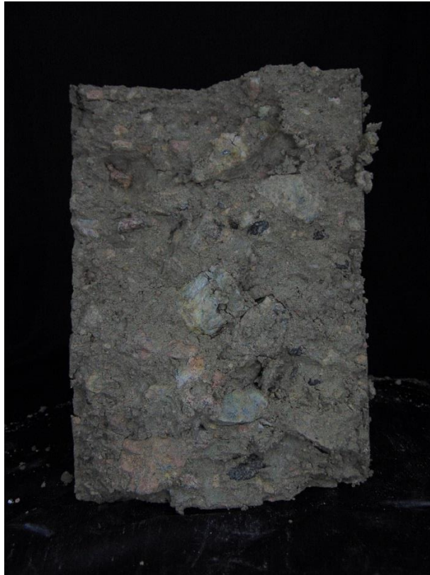
Figura 9. Probeta con humedad de 12.36% – Toma falla 1
