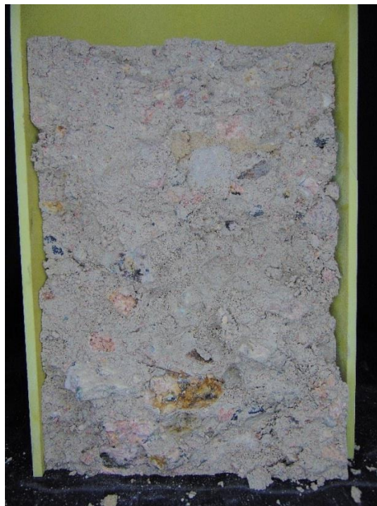
Figura 20. Probeta con humedad de 11.36% – Toma falla 2
