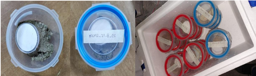
Figura 11. Muestra en recipiente hermético y montaje tipo sándwich
