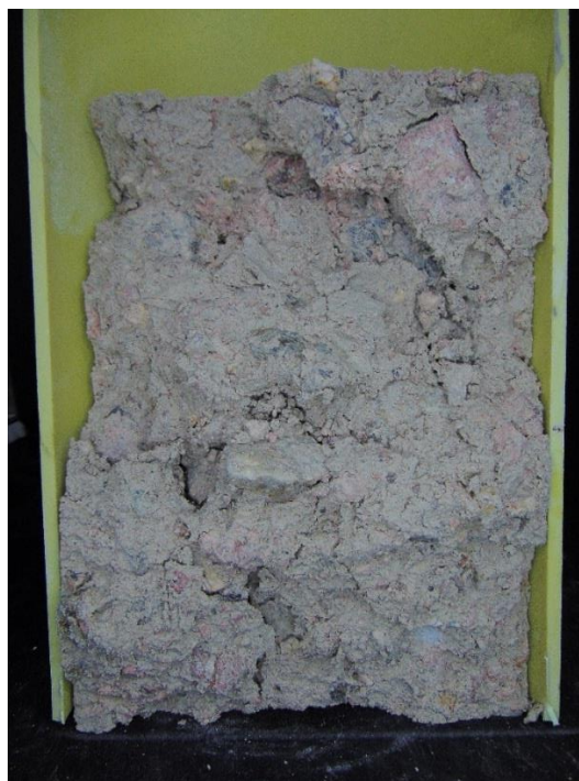
Figura 28. Probeta con humedad de 13.31% – Toma falla 2
