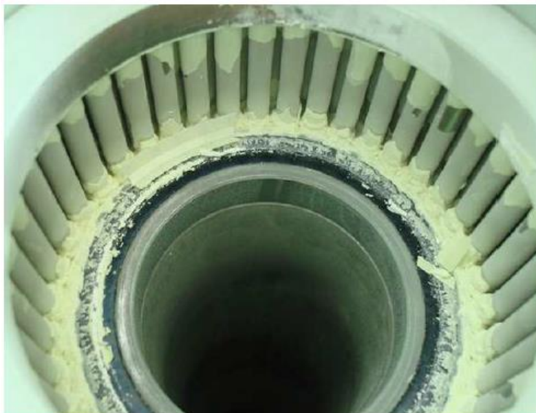
Figura 6. Deposición de Azufre en Internos de un Medidor de Flujo
