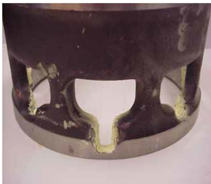
Figura 20. Azufre Elemental Depositado en la Jaula de una Válvula de Control
