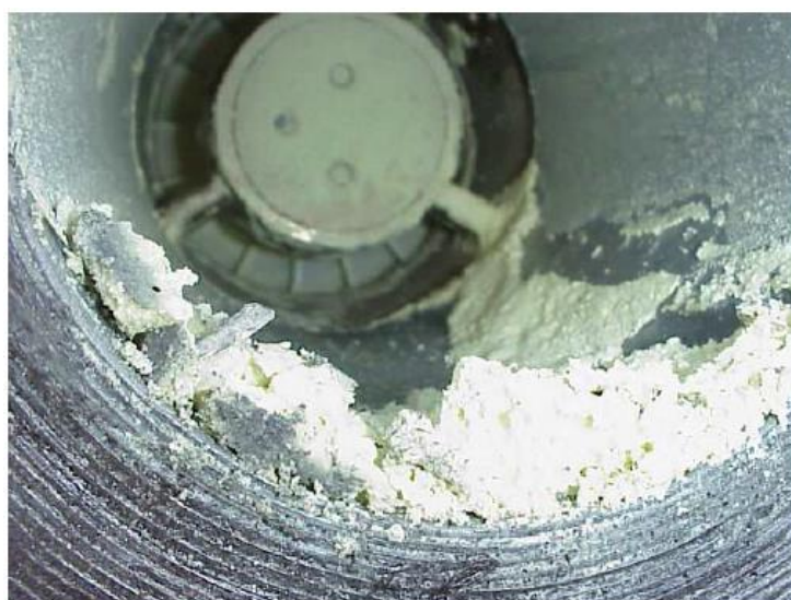
Figura 7. Deposición de Azufre Aguas Abajo de un Medidor de Flujo Tipo Turbina
