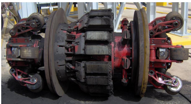
Figura 4. Raspador inteligente para remover el polvo negro del interior de las líneas de transmisión de Gas Natural
