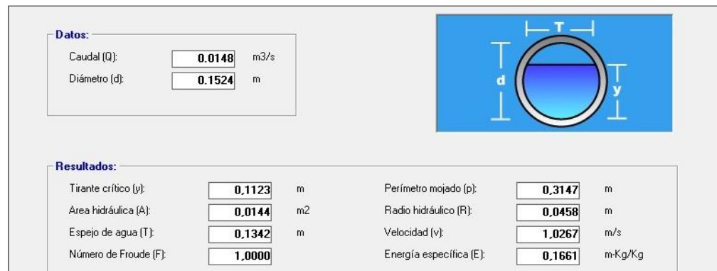
Figura 22. Verificación tirante hidráulico para tubería de rebose en el tanque de distribución Buenos Aires.
