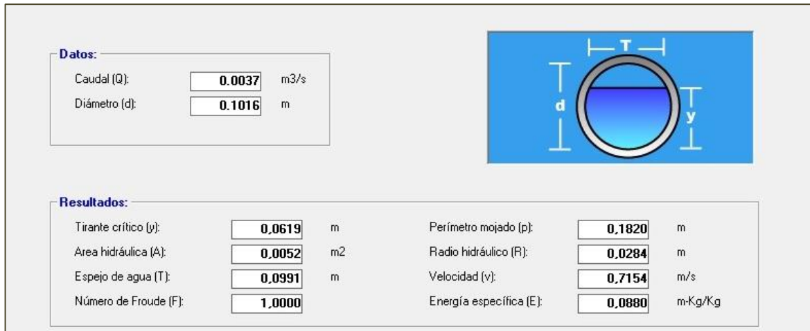
Figura 23. Verificación tirante hidráulico para tubería de rebose en el tanque de distribución Miraflores.
