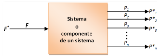
Figura 32. Sistema o componente de un sistema con un fuel y n productos.
