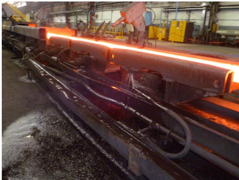
Figura 1. Refrigeración camino de rodillos Tren Morgan
