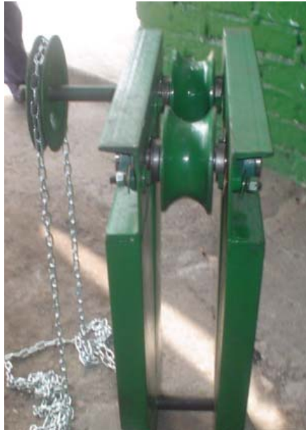
Figura 73. Montaje de las ruedas del carro.
