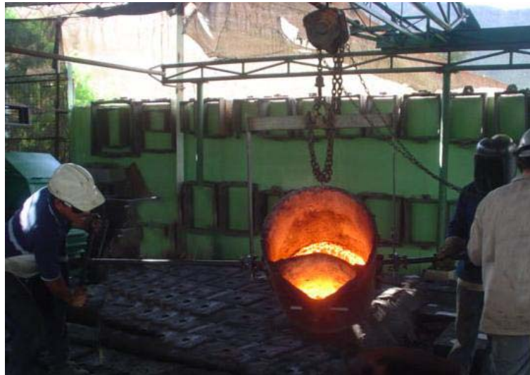
Figura 25. Volteo y vaciado de la cuchara.
