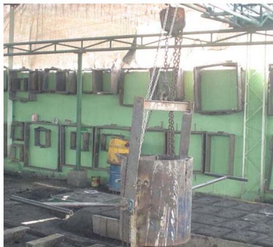
Figura 81. Transporte longitudinal de la cuchara.
