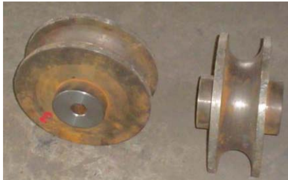
Figura 68. Ruedas del puente.
