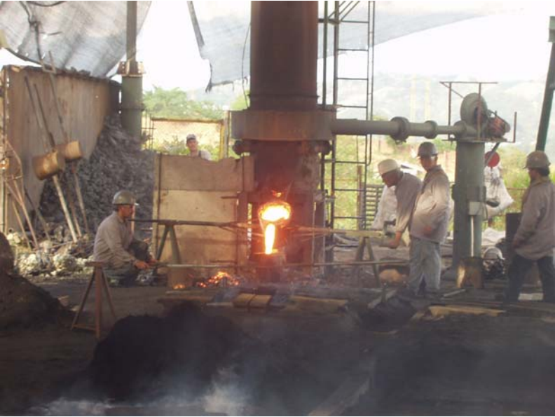
Figura 3. Transferencia del metal fundido de la cuchara mezcladora a la cuchara de mano.
