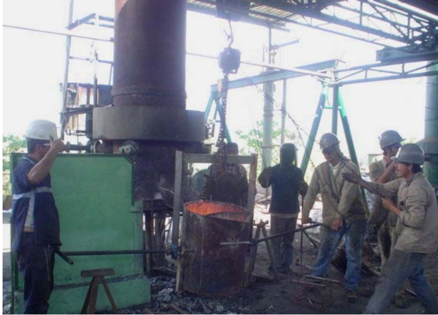
Figura 80. Elevación de la cuchara.
