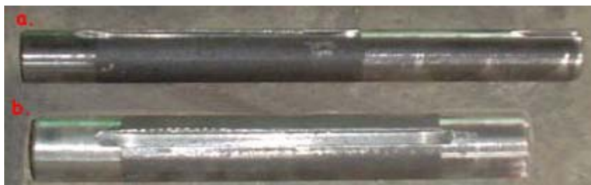
Figura 69. a. Eje de las ruedas motrices. b. Eje de las ruedas motoras.
