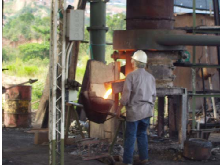
Figura 2. Descarga del horno.
