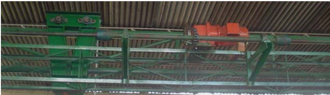
Figura 76. Montaje del eje de transmisión.
