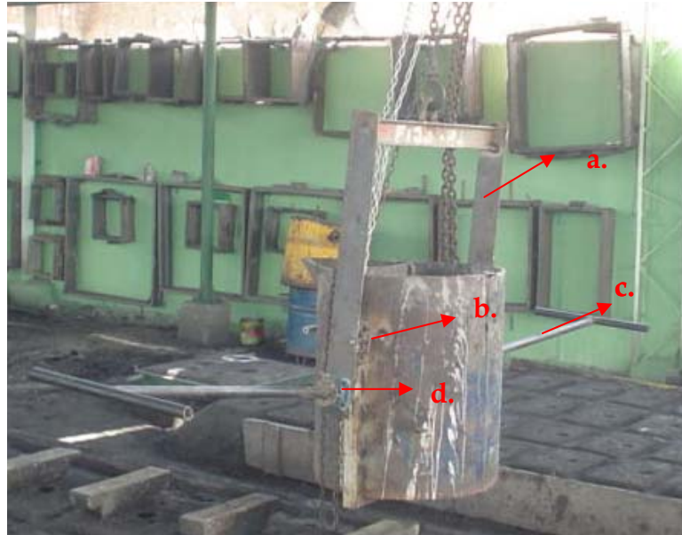
Figura 78. Ensamble de la abrazadera.
