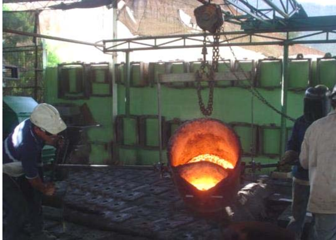
Figura 84. Volteo y llenado de los moldes.
