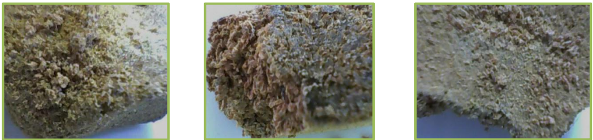
Imagen 7. Estructura interna de los aglomerados después de estar en contacto con los ácidos. (de izquierda a derecha: muestra 35, muestra 36 y muestra 39 en NaOH al 10%). Fuente: Autoras
