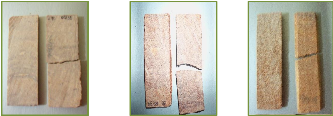
Imagen 11. Probetas antes y después del ensayo de flexión (en su orden, de izquierda a derecha; <70 (65:35), 50 (65:35) y 30 (65:35). Fuente: Autoras
