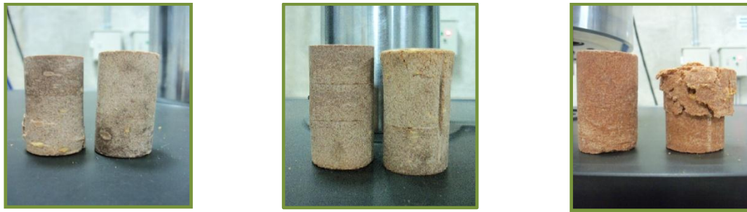
Imagen 10. Probetas antes y después del ensayo de compresión (en su orden, de izquierda a derecha; <70 (65:35), 50 (65:35) y 30 (65:35)). Fuente: Autoras
