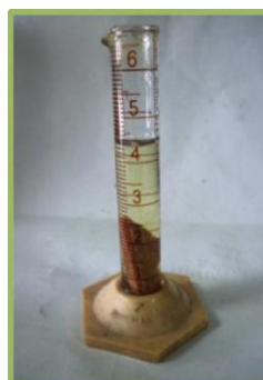
Imagen 13. Prueba de Densidad usando el principio de Arquímedes. Fuente: Autoras
