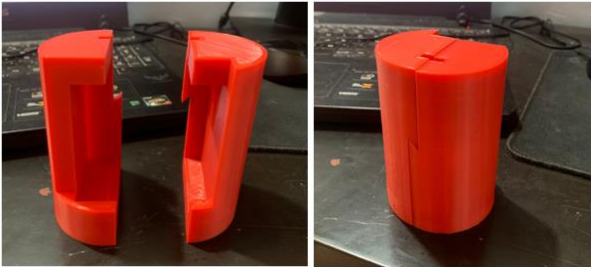
Figura 34 Vista frontal del soporte del servomotor
