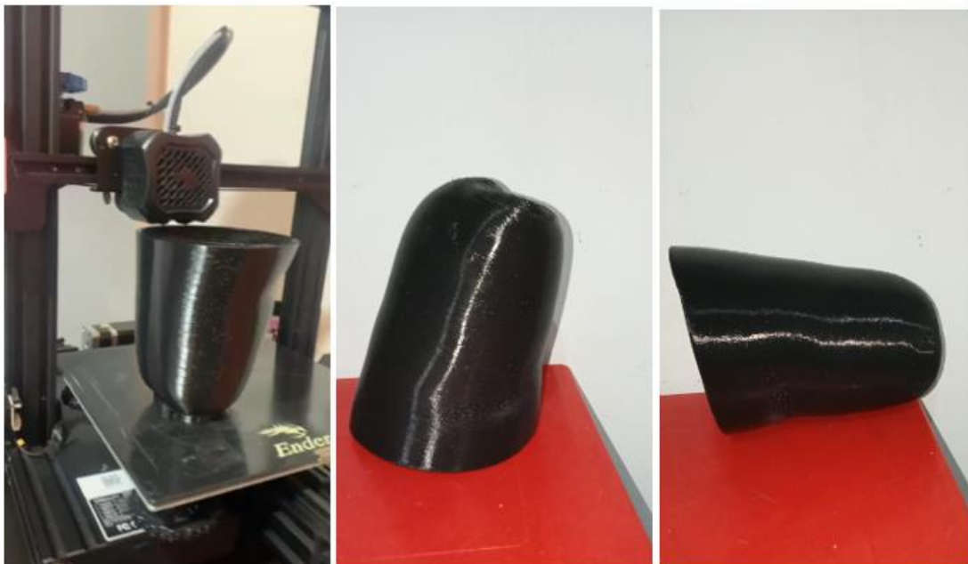
Figura 26 Proceso de impresión 3D de socket
