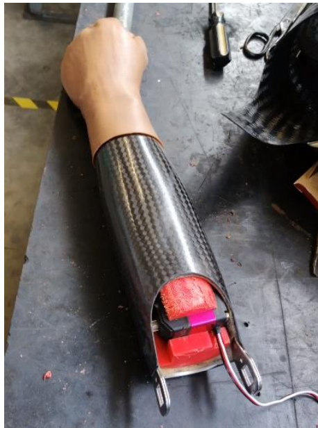
Ilustración 8 Vista superior del antebrazo de prótesis
