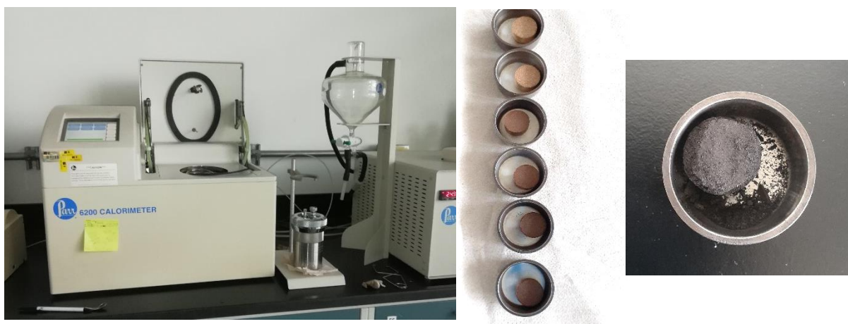
Figura 17. Realización de pruebas de poder calorífico.
