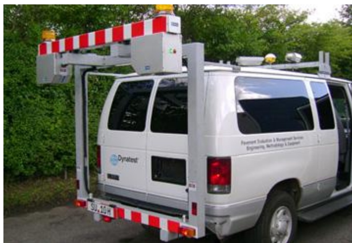
Figura 13: Ejemplo de un vehículo para la toma automatizada de datos. Sistema propio de ROADEX. 21
