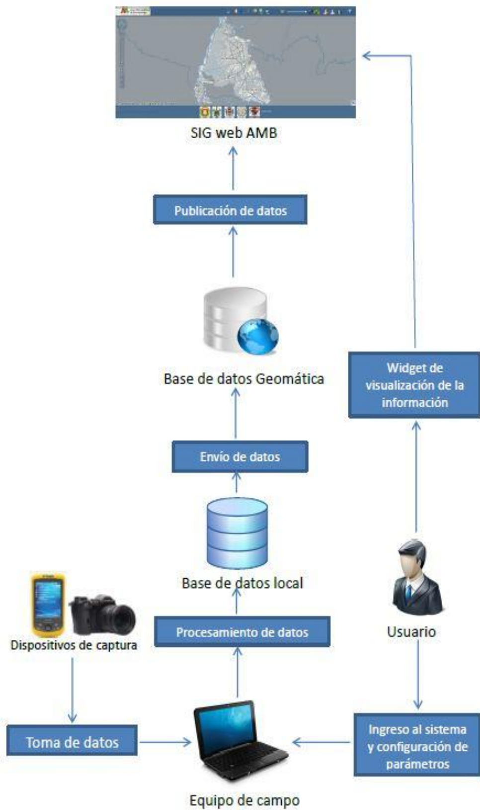
Figura 34: Diagrama de la arquitectura de los componentes software y hardware del sistema Fuente: Autoría propia
