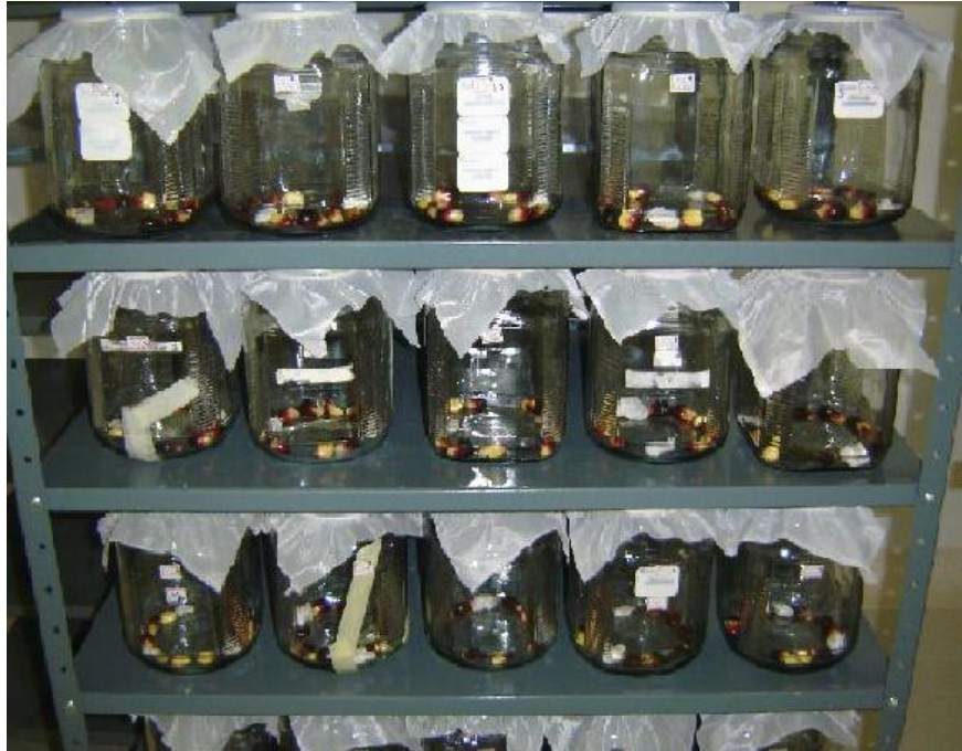
Figura 4. Montaje de las unidades experimentales en el cuarto de incubación. Disposición de los bloques aleatorizados.
