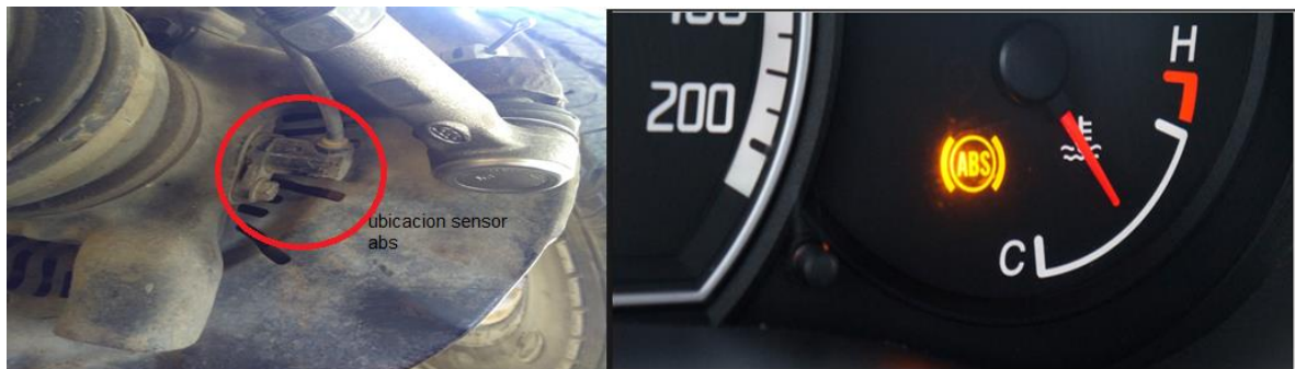
Figura 8. Ubicación sensor y señal ABS
