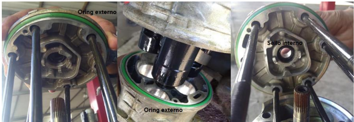
Figura 9. ubicación oring externo y sello interno
