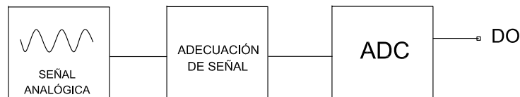
Figura 11.4: Adquisición de señal analógica
