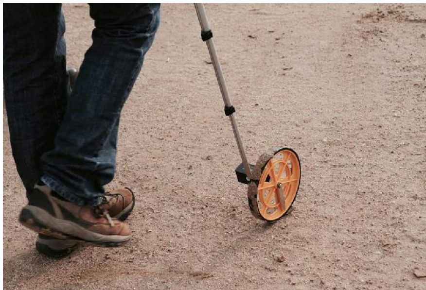
Figura 9. El Odómetro es utilizado para medir la longitud de la línea ERT .
