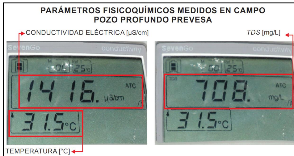
Figura 14. Valores de temperatura, TDS y CE medidos en campo con el equipo portátil SG23 marca METTLER TOLEDO.
