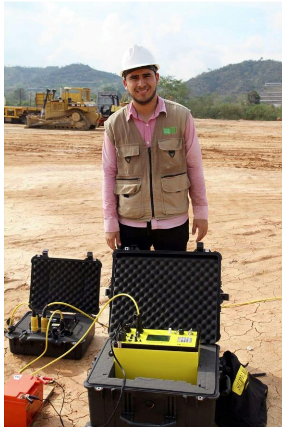
Figura 8. Equipo AGI Supersting R8 utilizado en los levantamientos ERT . El equipo está compuesto por una CPU, una switch box , una batería 12V, 8 cables, 56 electrodos y 56 pines.
