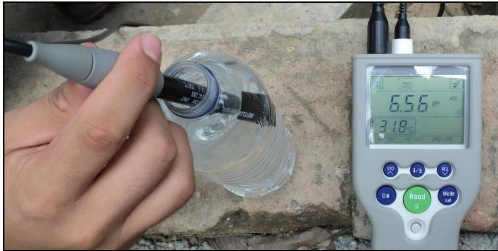
Figura 13. Medición in situ del pH con el equipo portátil SG23 marca METTLER TOLEDO.
