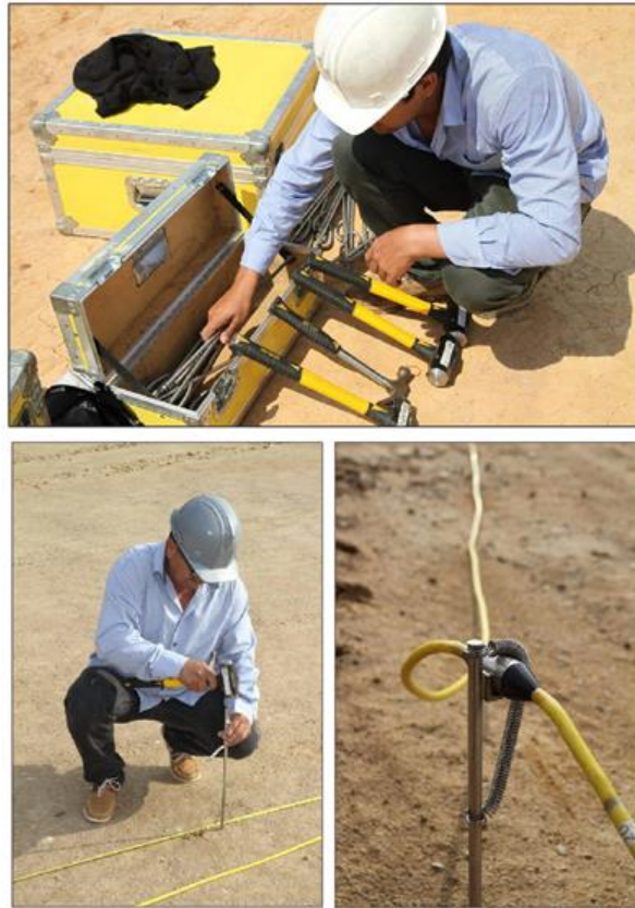
Figura 10. Los electrodos se disponen en línea recta para el levantamiento ERT . Se puede ver el contacto entre el suelo y el electrodo a través del pin. El espaciado entre los electrodos fue de 10 m en este caso, dando una longitud de línea ERT de 550 m en ISMOCOL (IM01).
