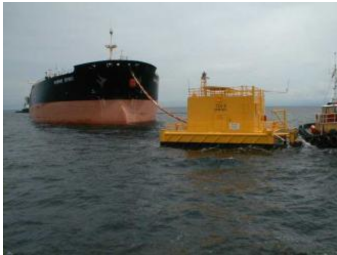
Foto 2: Cargue de Crudo de Tanquero en Monoboya o TLU
