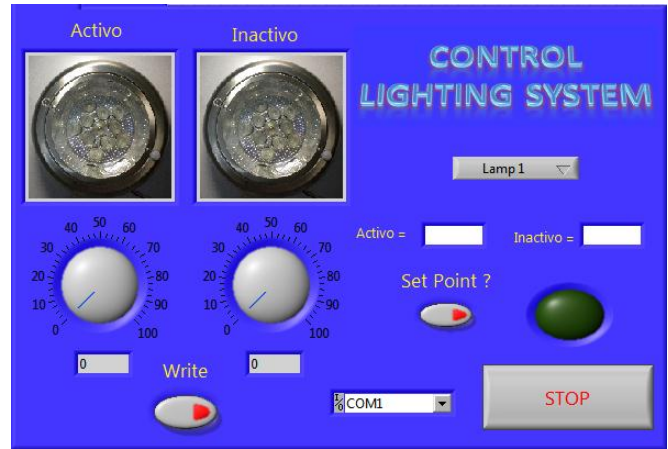
Figura 14. Panel frontal de la interfaz de control. Fuente: Autores
