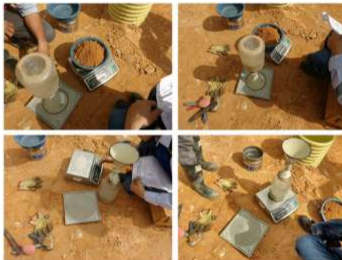
Figura 5. Control de densidad de compactación, ensayo de cono y arena. INVE - 161 - 2013.
