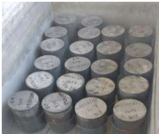
Figura 18. Cilindros de concreto en pila de curado.
