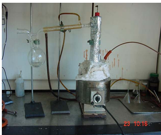
Figura 11a. Montaje destilación atm.
