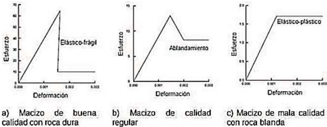
Figura 3 Características de falla para macizos rocosos de diferente calidad y comportamiento. Note que las escalas de esfuerzos son diferentes. Modificada de Hoek (1997)
